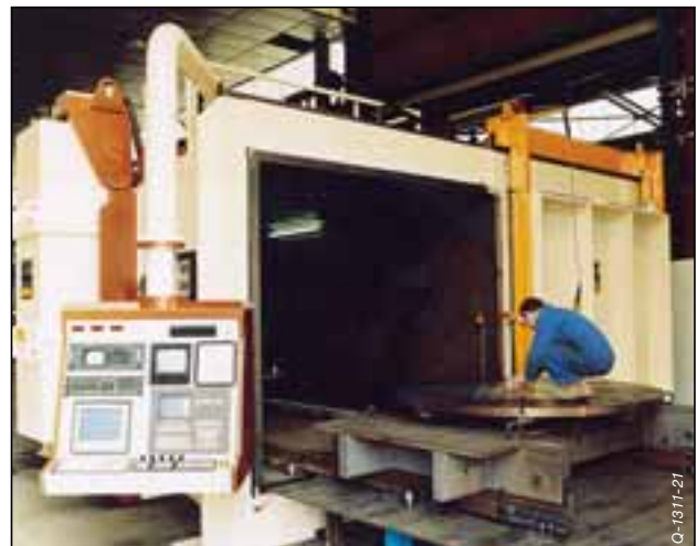
Elektronenstrahl- Schweißmaschine mit einer 40 m 3 Kammer und einer Standard-Stromversorgung von 30 kW
