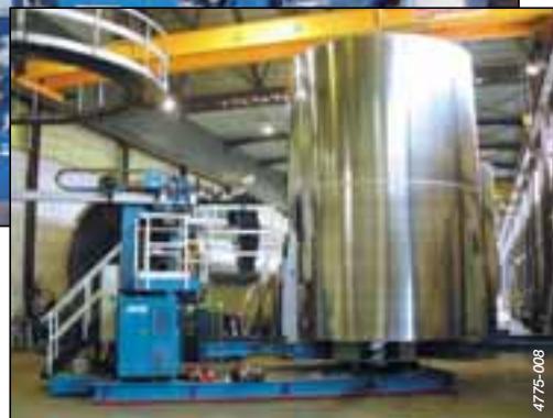
Edelstahl-Behälter mit Keyhole- Plasma-Verfahren geschweißt
