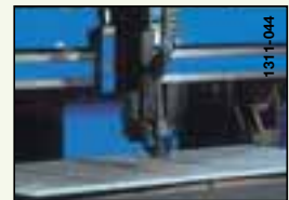
PO 251 Werkzeughalter Verfahrweg 250 mm
