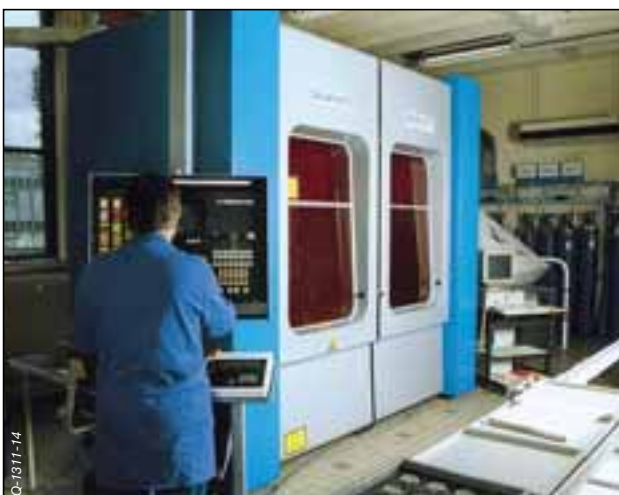
Schweißmaschine mit 2 Arbeitsstationen zur parallelen Beladung/Entladung, 4 programmierbaren Achsen, Teile-Erkennungs-Vorrichtung
