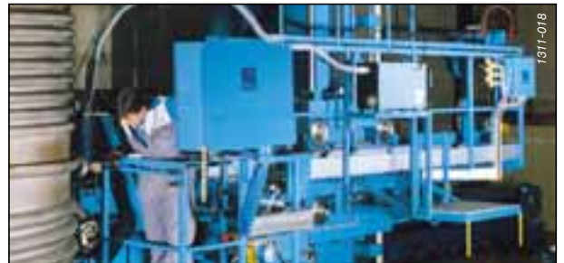
Spezial-Schweißautomat zum Schweißen von Rohrleitungen an Behälter
