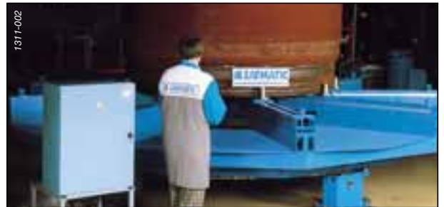
Motorisierter Hochleistungsdrehtisch zum Schweißen von Rohren
