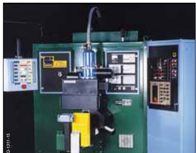
Elektronenstrahl-Schweißmaschine für die mechanisierte Fertigung; ausgerüstet mit der Stromversorgung ST 10 für die Automobilindustrie : Durchgängige Produktion: Garantiert bis zu 500 Teile/Stunde; wir garantieren eine Kathoden-Lebensdauer von 400 Stunden
