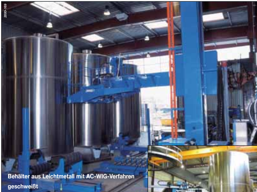
Edelstahl-Behälter mit Keyhole- Plasma-Verfahren geschweißt
