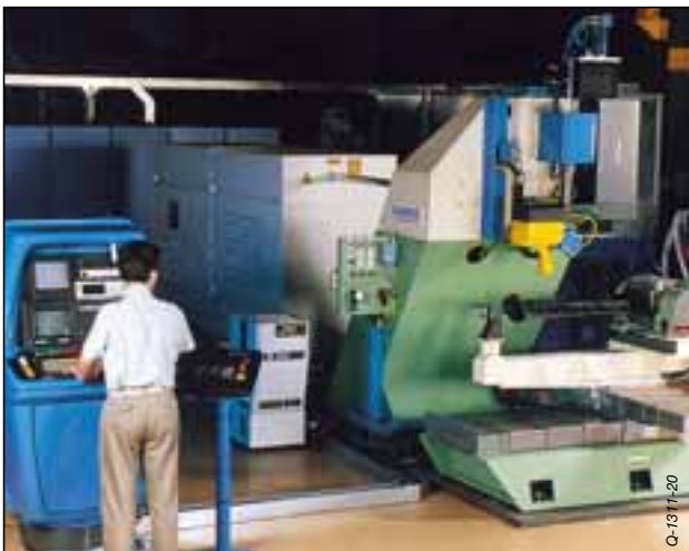
5-achsige Laser-Anlage: XY Tisch 600 mm x 1000 mm, drehbare mit Winklereinstellung, Z-Bewegung 500 mm, Nahterkennung, Echtzeitbetrachtung
