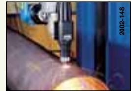
POC 50 Werkzeughalter Verfahrweg 50 mm
